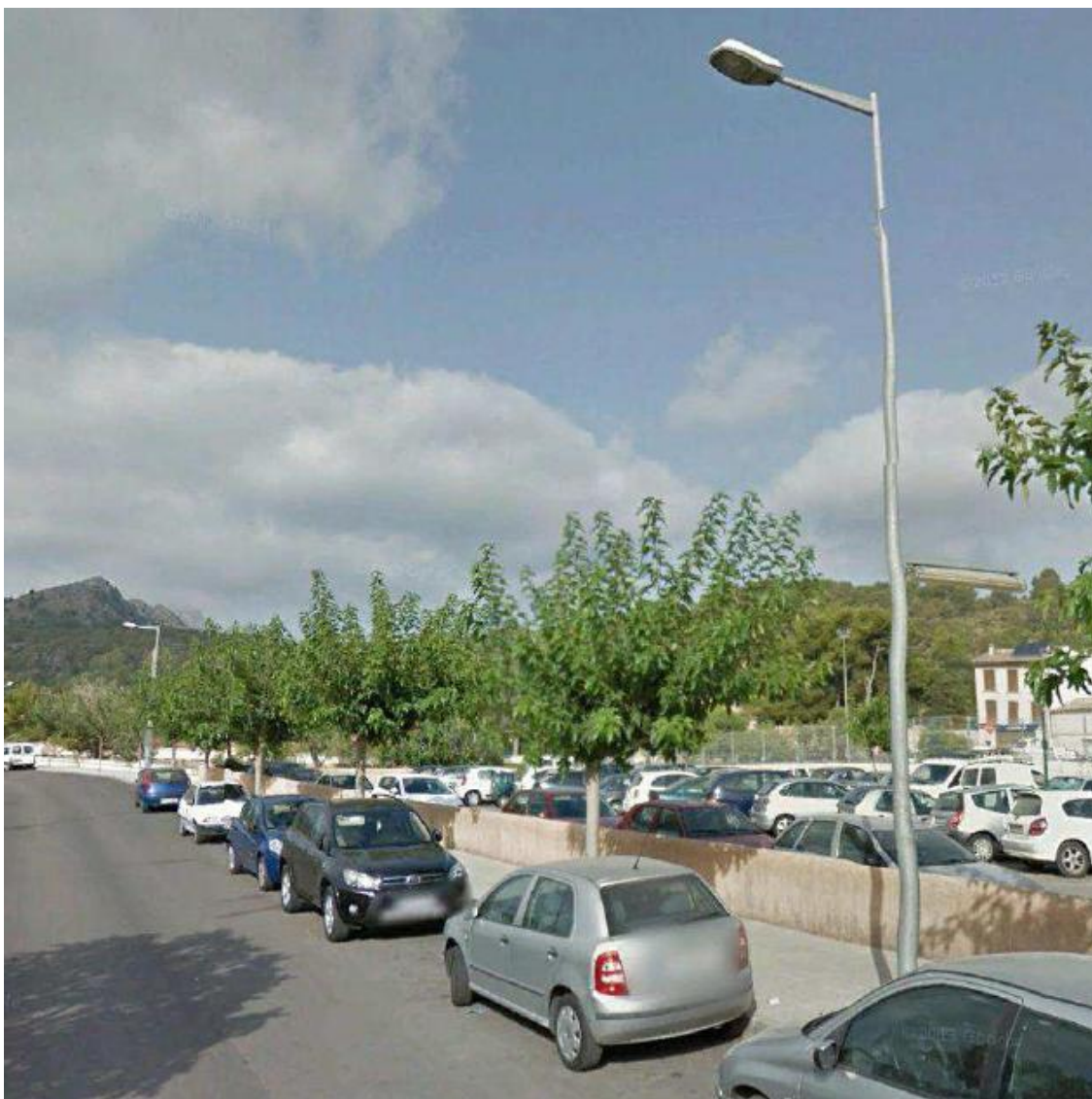
Farola tipo Cecili Metal baculo 8 metros con tubo fluorescente a 4 metros.
